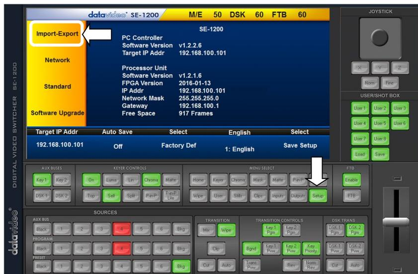
PC から the SE-1200MU にスチル(静止画像)を読込むには **Import Still** (スチルの読込) を選択します。
