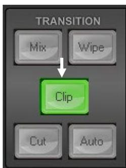
TRANSITION パネルの **Clip** (クリップ) ボタンを押して、クリップトランジションを選択します。プログラムソースの映像を Preset (プレビュー) ソースで選択されている次の映像に切替えるときに使います。
