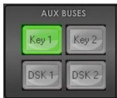
SE-1200MU には 4 種類の専用キーヤーKey1、Key2、DSK1、DSK2 があります。すべてのキーヤーを同時に使用することが可能です。Key 1 と Key2 はアップストリームキーヤー、または、ダウンストリームキーヤーとして設定することができます。
