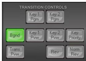
2つの映像ソースをクリップで切替えるには、まず、トランジションの背景のトランジション、または、TRANSITION CONTROLS パネルの **Bgnd**(背景)ボタンがオン(緑色に点灯)になっていることを確認します。
