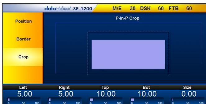
**Left**(左端)、**Right**(右端)、**Top**(上端)、**Bottom**(下端)は個々にクロップ(切取る)の値を調整できます。または、**Size**(大きさ)の値で調整します。ピクチャーインピクチャーの端を調整するためにそれぞれの値をクリックします。
