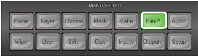
ステップ 5: MENU SELECT パネルの **P-in-P**(ピクチャーインピクチャー) ボタンをクリックし(緑色に点灯)、ピクチャーインピクチャー機能に移ります。
