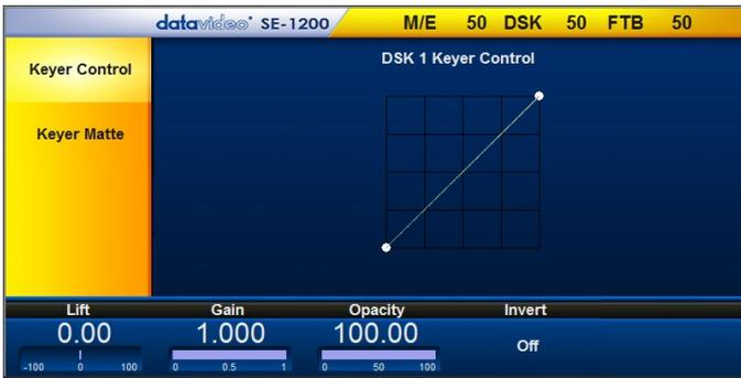
のキーを調整します。**Lift**(リフト)、**Gain**(ゲイン)、**Opacity**(透過度)、**Invert**(反転)の各機能の詳細については、[キーヤーコントロール\(7.1.1\)](#)で説明します。
