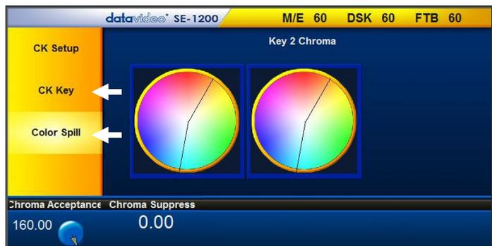
**Step 5:** クロマキーを調整するには、MENU SELECT パネルの **Chrom** ボタンをクリックします。前節の CK Key や Color Spill を使用したキーの調整方法を参照して調整します。(8.3、8.4)
