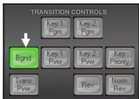
2 つの映像ソースをディゾルブで切替えるには、まず、背景のトランジション、または、TRANSITION CONTROLS パネルの **Bgn'd(背景)**ボタンがオン(緑色に点灯)になっていることを確認します。
