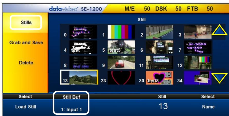
4. 画面の下部の Still Buf(スチルバッファ)オプションを変更します。スチル(静止画像)を表示する入力 ch を選択します。この例では、**Input 1**(入力 1)を選択します。
