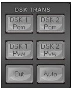
DSK TRANS パネルでダウンストリームキーヤーのオン(有効)とオフ(無効)を切替えます。放送のプログラム出力に送出する前に選択されているキーヤーをプレビュー出力で確認することができます。
