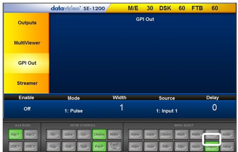
この機能は datavideo の NVP-20 や HRS-30、HDR-60/70 などのプレーヤーを再生するときのトリガーとして使用します。
