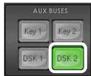
ステップ1: 使用するDSKキーヤーのchを選択します。ここでは AUX BUSESパネルの**DSK 2**ボタンをクリックします。
