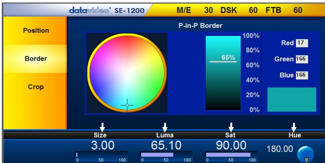
**Luma**(ルミナンス)、および、**Saturation**(サチュレーション)、**Hue**(ヒュー)、**Size**(幅)によりピクチャーインピクチャーウィンドウのボーダーを指定します。
