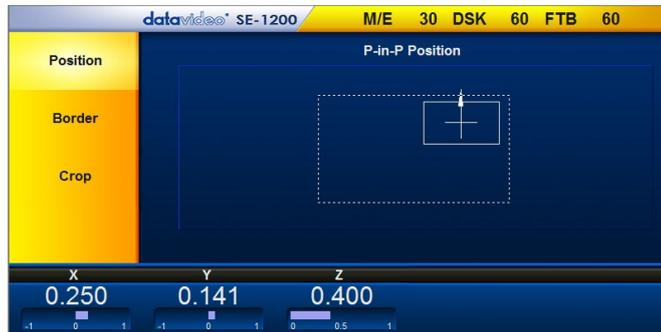
ステップ 6: 黄色いメニューにピクチャーインピクチャーのオプション **Position**(表示位置)、**Border**(ボーダー)、**Crop**(クロップ)が表示されます。
