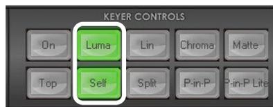
**ステップ 2:** 使用するキーヤーの種類を選択します。ここでは KEYER CONTROLS パネルの **Luma**(ルミナンス)ボタンをクリックします。
