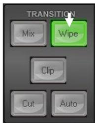
TRANSITION パネルの **WIPE(ワイプ)** ボタンを押して、ワイプエフェクトを選択します。プログラムソースの映像を Preset(プレビュー)ソースで選択されている次の映像に切替えるときにワイプエフェクトを使います。
