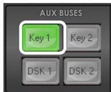
**Step 1:** AUX BUSES パネルのクロマキーch (Key 1 or Key 2) を選択します。この例では AUX BUSES パネルの **Key 1** ボタンを使用します。
