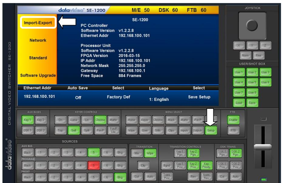
PC から SE-1200MU にユーザー設定ファイルを読み込むには、**Import User** (ユーザー設定を PC から読み込) を選択します。
