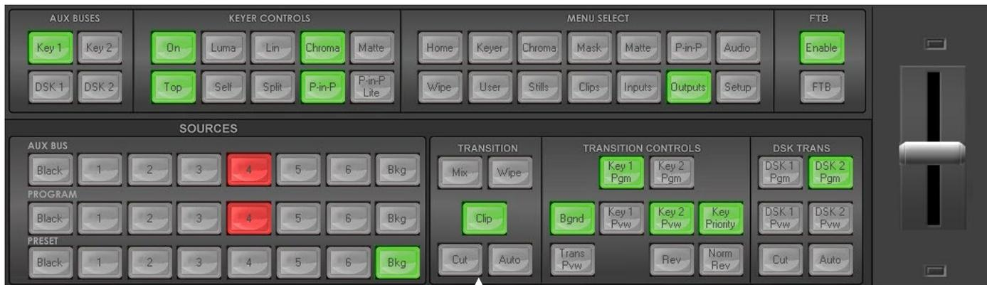
2. 下部の **Preset(プレビュー)ソース**のボタンで次のソースを選択し、TRANSITION パネルの **CUT(カットチェンジ)**ボタンを押します。
