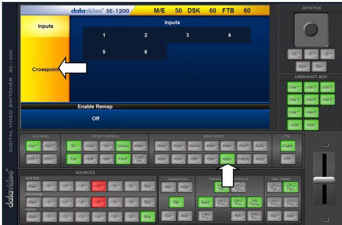
**Inputs**(入力)メニューの **crosspoint**(クロスポイント)を使用して SE-1200MU の入力ソースの構成を入替えることができます。
