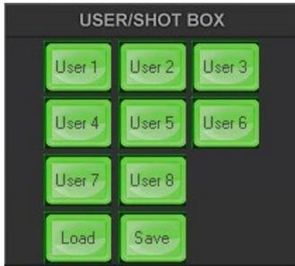
SE-1200MU に保存した設定を読み込むには、USER/SHOT BOX パネルの **LOAD (読み)** ボタンをクリックすると、数値入力パッドが表示されます。
