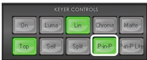
ステップ 2: KEYS CONTROLS パネルの **P-in-P** (ピクチャーインピクチャー) ボタンをクリックし (緑色に点灯)、Key 2 エフェクトを選択します。
