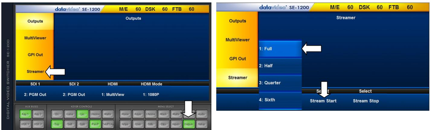
画面の大きさを小さくすることによりマルチビューの IP ストリーム配信による IP ネットワークの通信帯域 (データ量) を小さく抑えることができます。
