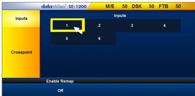
2. 映像入力 ch を選択するボタンが 6 個表示されます。フリーズする映像入力の **ch** のボタンをクリックします。
