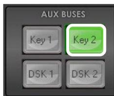
ステップ 1: AUX BUSES パネルの **Key 1**、または、**Key 2** から使用するキーの ch を選択します。ここではピクチャーインピクチャー (PIP) 画面用に **Key 2** ボタンをクリックします。
