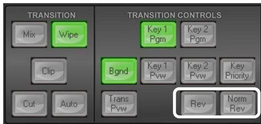
Norm / Rev ボタンがオン(点灯)の場合は、毎回ワイプの方向が変わります。Rev ボタンのオン(点灯)とオフ(消灯)が切替わり、次の方向を示しています。
