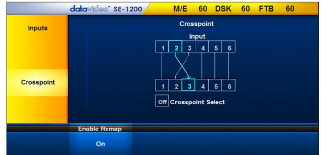
クロスポイント(下の列)をクリック後、入力(上の列)をクリックし結びつけます。上の例では、入力2と入力3を入れ替えています。
