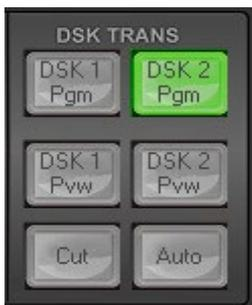
DSK 1/Pgm、DSK 1/Pvw または、DSK 2/Pgm、DSK 2/Pvw のオン(有効)とオフ(無効)を切替えることができます。選択されたボタンは緑色に点灯し、マルチビューのプレビュー画面で DSK 付の映像を確認することができます。
