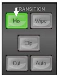
TRANSITION パネルの **MIX(ディゾルブ)**ボタンを押すと、ディゾルブエフェクトが選択されます。プログラムソースの映像を Preset(プレビュー)ソースで選択されている次の映像に切替えるときに使います。
