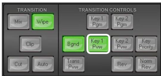
**Step 4:** プレビュー出力には、すでにクロマキー合成した映像が表示されています。表示されていない場合は、TRANSITION CONTROLS パネルの **Key 1/Pvw** ボタンをクリックすると緑色に点灯し、切替わります。
