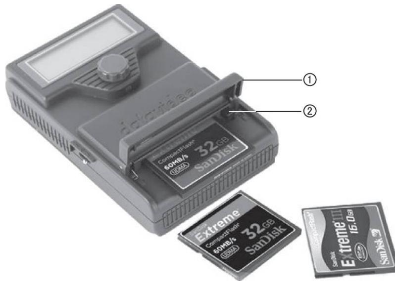
① CFカード保護カバー - 下方にスライドし、慎重に持上げカバーを開けると、CFカードや取出しボタンにアクセスできます。
