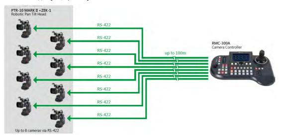
カメラコントローラーを使用してPTR-10MARK IIに取り付けたカメラを制御するには、まずコントローラーの背面にあるRJ-45ポートの1つをRJ-45ケーブルでPTR-10 MARKIIのRS-422INポートに接続します。次に、使用するプロトコルに応じて、PTR-10 MARKIIと、リモートケーブルによってリモートポート (LANC/BX-Lens)と繋いだカメラかRJ-45ケーブルによってRS-232 / 422出カポート(RS-232 / RS-422)と繋いだカメラを接続して下さい。リモートケーブルについては、リモートOUTのセクションを参照してください。
