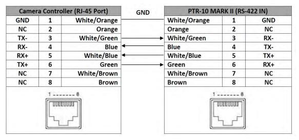
接続を確立する前に、PTR-10 MARKIIのDIPスイッチのbit4をオフに設定する必要があります。詳しくは、「DIP Switch」セクションを参照してください。
