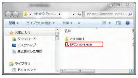
⑤PC 上で EP Console を開き、認識したシステム設定に応じて、検出された COM ポートを選択し、ボーレートを設定します (推奨 Baud は 57600 bps です)。
