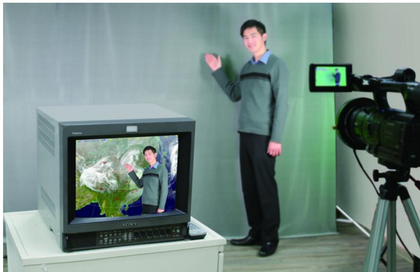
RF-3025 は大きさ 3m x 2.5m の再帰性反射スクリーンです。
