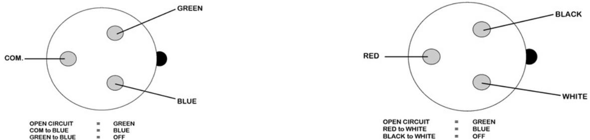
LD-1 には、2m のリモートコントロールケーブルが付属しています。これは、選択したアプリケーションにインテグレーションするために使用します。上の図は、付属ケーブルのカラーコーディングを説明しています。
