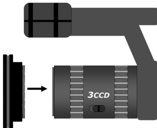
ライトリングをマウントリングに並べます。4つのグラブねじが、ねじ込みすぎて不安定な状態になっていないか注意して下さい。
