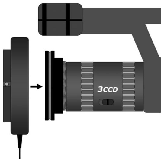
ライトリングをマウントプレートに押し込むと、グラブねじがマウントリングの前側にある溝の位置にきます。
