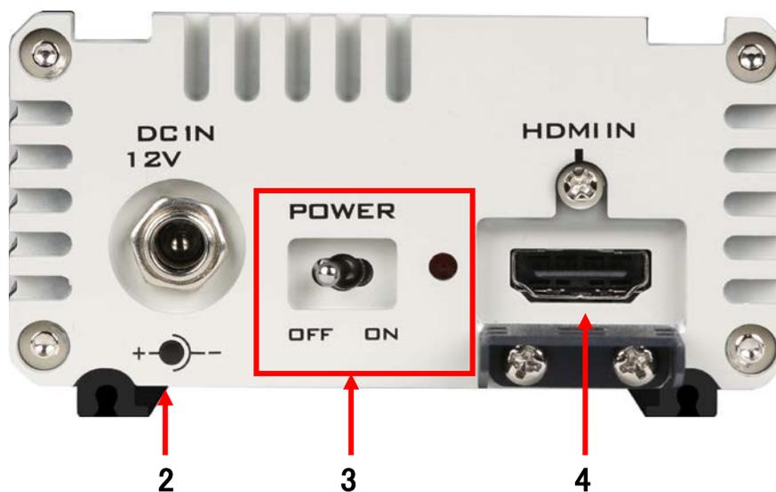
2. DC電源入力コネクタ(付属のAC/DC変換アダプタを接続します)
