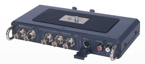
DAC-7 は、アナログの映像と音声を SD-SDI に変換し、高画質の映像を最長 120m 送信することができます。 Datavideo ハンドキャリースタジオシリーズや SDI 対応スイッチャー、レコーダーなどの SDI 対応機器に接続するのに最適です。 DAC-7は、頑丈な金属製の筐体で、ビデオカメラと三脚の間に取付けられるよう設計されています。 NTSC 方式と PAL 方式に対応。
