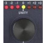
設定値を工場出荷時の初期状態にリセットする場合は、該当する機能のボタンを押した後、調整つまみを押し込みます。1 秒後、工場出荷時の初期状態にリセットされます。
