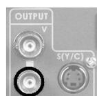
お手持ちのレコーダーが S-Video 入力コネクタを備えていない場合は、BNC ケーブルで DVK-200 の背面にある OUTPUT のコンポジット出力コネクタと接続します。
