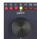
設定値を工場出荷時の初期状態にリセットする場合は、該当する機能のボタンを押した後、調整つまみを押し込みます。1 秒後、工場出荷時の初期状態にリセットされます。
