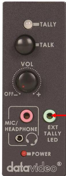
TB-5、または、ITC-100SLに付属のφ3.5mmステレオミニケーブルを使用し、TD-2を接続します。
