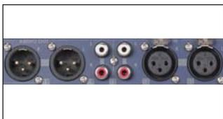
音声は、不平衡型 (RCA) と平衡型 (XLR) に対応。音声ディレイ機能により、映像と音声の同期が可能
