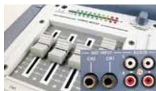
2ch のマイク入力とステレオ 1ch の AUX 入力対応の音声用ミキサーを内蔵。
