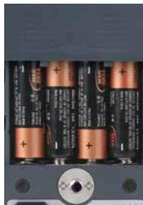
DN-60Aは、4本の単三乾電池で動作します。充電式の単三電池も使用でき、1回のチャージで2時間以上の連続録画が可能です。もちろん外部電源も使用できます。
