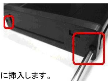
USB ポートとシリアル ATA ポート側を奥にし、カートリッジを DN-600/700 本体に挿入します。確実に差込んだことを確認し、レバーを左側に倒しカートリッジを固定します。
