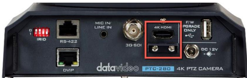
HDMIケーブルを使用して、HDMI OUTを外部接続モニタに接続します。
