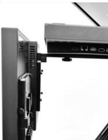
②モニターに 75mm VESA マウントがある場合は、14mm M4 ネジ（アイテム U）を使って、垂直マウントレール（アイテム S）にモニターを直接取り付けます。
