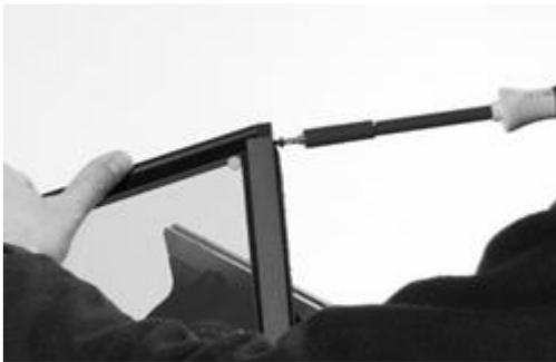
④ガラスフレーム（アイテム G）の左右にある溝に 70/30 ミラーガラスシート（アイテム J）をスライドさせて取り付けます。
