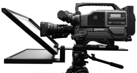
⑪ お手持ちの三脚アダプタに ENG カメラを取り付けます。また、レンズと 70/30 ミラーガラス (アイテム J) の中心から距離が 1~2cm 程離れるようにフレームをスライドさせ、位置を調節します。
