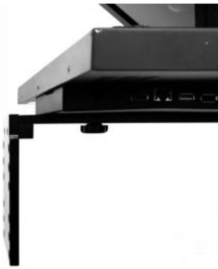
①タレントモニター垂直マウントレール（アイテム S）を取り付け、ENG プロンプターフレーム（アイテム B）の下側に M4 ネジ（アイテム BB）で固定します。
