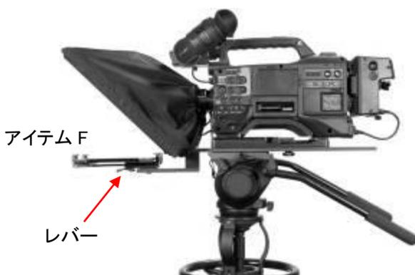
(16) 設定済みのタブレットをタブレットホルダーに取り付け、ホルダーの位置をタブレットのサイズに合わせて調節します。
