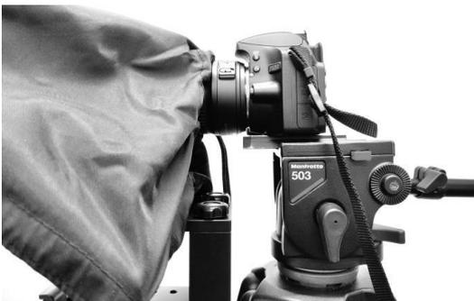
(10) 光を遮断する為にプロンプターフード(アイテム I)でカメラレンズを覆い、留めひもで締めつけます。
