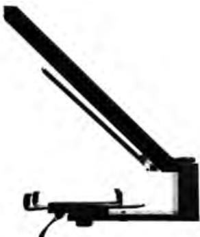
(6) タブレットアジャストホルダー(アイテム F)を、下部のスペーサーブロック付きレール(アイテム B)に取り付けます。アイテム B のマウントフックをアイテム F の底面の穴にはめ込み、アイテム F を B に固定します。
