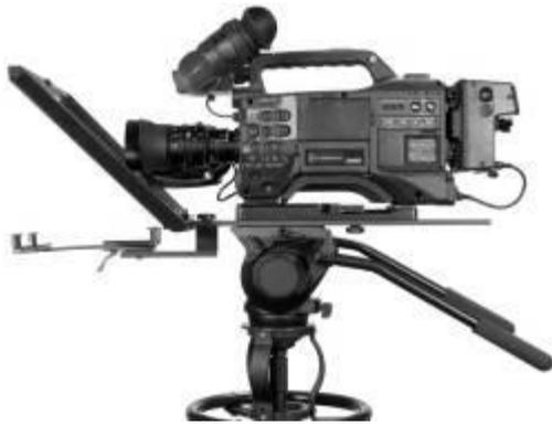
(11) お手持ちの三脚アダプタに ENG カメラを取り付けます。また、レンズと 70/30 ガラス(アイテム J)の距離が 1~2cm になるようにフレームをスライドさせ、位置を調節します。その際、カメラのレンズと 70/30 ガラス(アイテム J)を傷つけないように注意してください。
