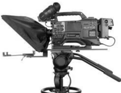
(14) 光を遮断する為にプロンプターフード(アイテム I)でカメラレンズを覆い、留めひもで締めつけます。
