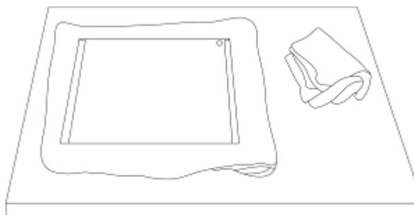
クリーニング液を直接ガラスに付けないでください。代わりに布に少量のクリーニング液を含ませるか吹きかけてください。
