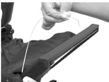
9. フードサポートワイヤをガラスフレームの穴に差し込みフードがレンズの視界を妨げないようにします。
