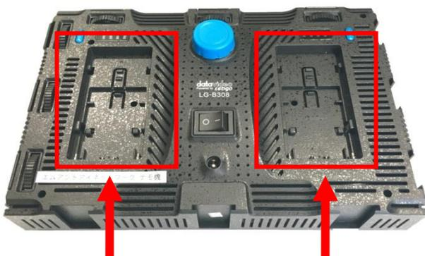
③電池パックアダプターを極板へセット、電源スイッチを入れます。
