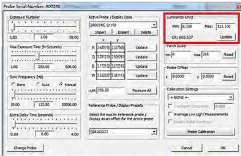
モニターのバックライト値を調整して、上のウィンドウの右上にある[輝度単位]ペインの[更新]ボタンをクリックします。Update ボタンをクリックするとすぐに、Calibration Status ウィンドウと Calibration Area およびダイアログボックスが表示されます。校正エリアを TLM-170V にドラッグします。最後にプローブをできるだけキャリブレーションエリアに向けてから、ダイアログボックスの OK ボタンをクリックしてキャリブレーションを開始します。Luminance Units ペインの MAX 値が 80~120 の範囲になるまで、この手順を繰り返します。MAX 値を 100 に近づけば近いほど、TLM-170V のキャリブレーションは良好になります。
