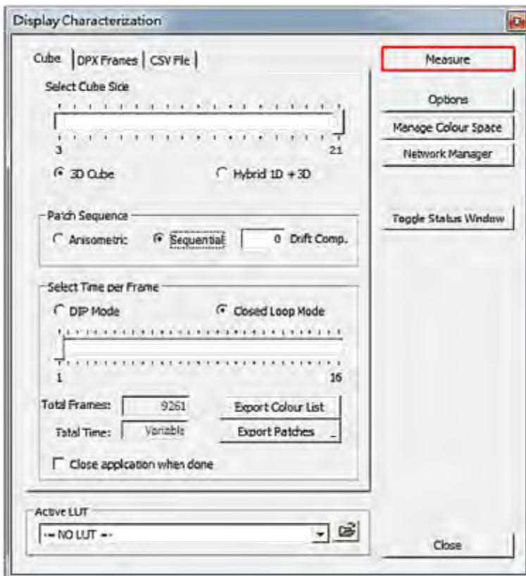
Measure ボタンをクリックすると、Calibration Status ウィンドウが Calibration Area とダイアログボックスと共に表示されます。校正エリアを TLM-170V にドラッグします。最後にダイアログボックスにこの特定のキャリブレーションの名前を入力し、プローブをできるだけキャリブレーションエリアに向けてから OK ボタンをクリックしてキャリブレーションを開始します。9261 点の測定を実行するのに約 1 時間かかることに注意してください。
