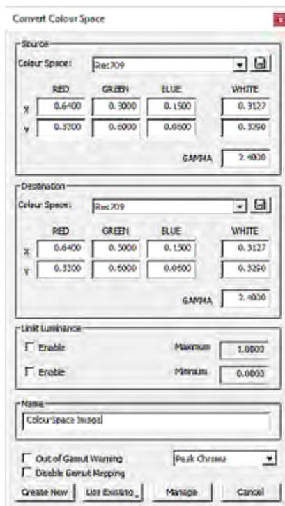
[ツール]→[カラースペース]→[カラースペースの変換]の順にクリックして、[カラースペースの変換]ウィンドウを開きます。[Source]ペインと [Destination]ペインで、色空間に Rec709 を選択します。 [名前]テキストボックスに、3D キューブカラーキャリブレーションファイルの名前を入力します。残りの設定は、次の図に示すように構成する必要があります。色変換データを生成するには、[新規作成]ボタンをクリックします。
