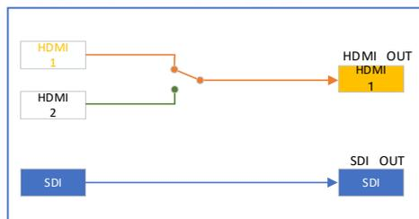
クロスコンバート機能OFFの場合 SDI を選択するとSDI出力にはSDIに入力された信号が出力される。この時HDMI出力はHDMI 1 が出力される。HDMI 2 に信号を入力された場合はHDMIOUTから出力されないHDMI出力信号が必要な場合はHDMI 1 に信号を入力してください
