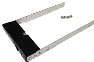
2.5 インチ ディスク用アタッチメント (固定ネジ4個含)
