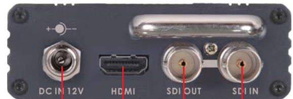
DC 電源入力 12V 3.6W HDMI 出力 HD/SD-SDI 出力 HD/SD-SDI 入力
