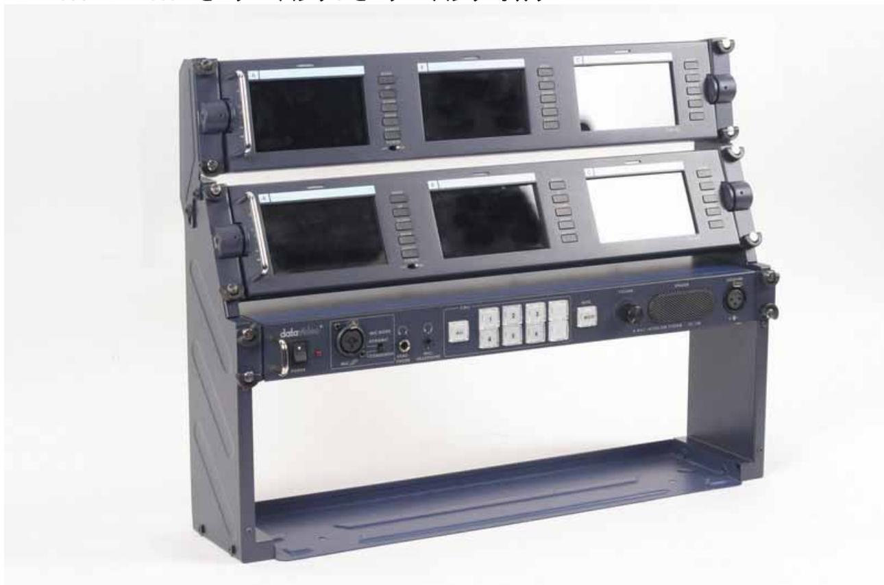
Datavideo 社製 TLM-433TFT LCD モニター・バンクは、SE-1000 にとって理想的なモニタリング・バンクです。上の写真は、TLM-433 を 2 台装備したもので、6 つのプレビュー・モニター（入力チャンネル用が 5 つ、AUX または PVW 出力用が 1 つ）があります。各モニターには、それぞれ上に 2 色ののタリー・ライトが付いており、ライブ・ソースとキュー・ソースを表示します。
