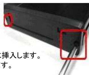
USB ポートとシリアル ATA ポート側を奥にし、カートリッジを HDR 本体に挿入します。確実に差込んだことを確認し、レバーを左側に倒しカートリッジを固定します。
