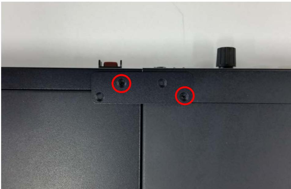
上部連結用プレート ② を合わせて該当する部分のネジを外し、
