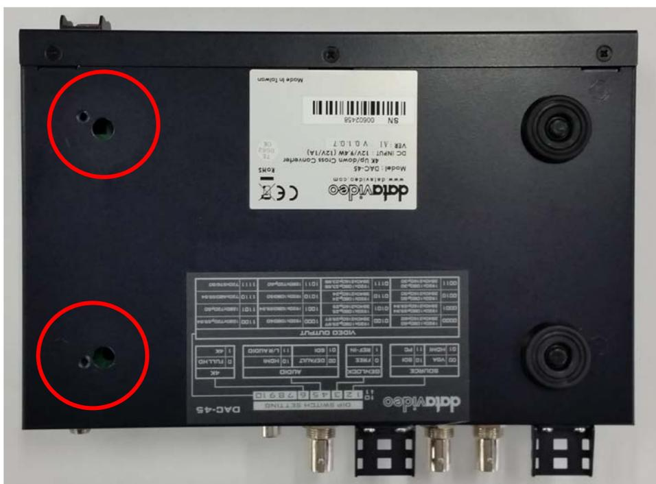
本体を左側へ寄せて取り付けるには、ラックイヤー金具 ① を左側に M4 × 8 mm (黒) ラックイヤー固定用ネジ ⑦ を 2 本で固定します。
